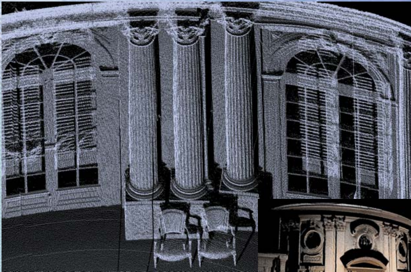
Original 3D-Scanner Messpunkte einer Innenansicht. Außenscan mit RGB Echtfarben.
